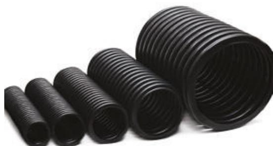
Fabricada com Polietileno de Alta Densidade (PEAD), a linha **techduto SD** atende aos principais requisitos das normas internacionais IEC 61386-24 (*Conduit System Buried Underground*) e EN 50086-24:1994 (*Conduit Systems for Cable Management, Particular Requirements for Conduit System Buried Underground*), passando em rigorosos testes de compressão (450 N).
