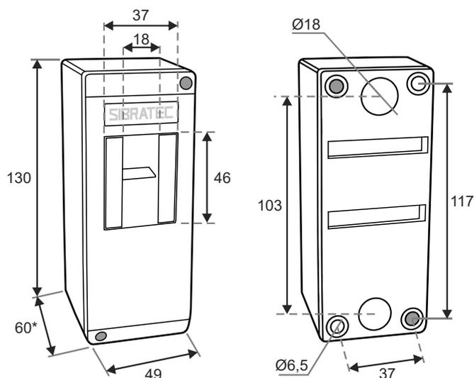
\*Caixa com o Disjuntor SIBRATEC a profundidade passa a ser 78mm
