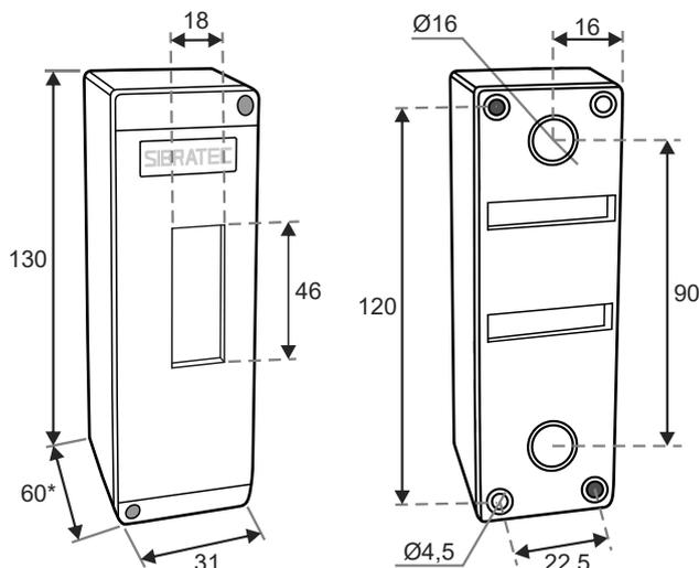
\*Caixa com o Disjuntor SIBRATEC a profundidade passa a ser 78mm
