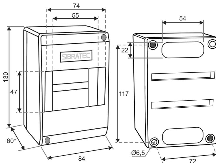
\*Caixa com o Disjuntor SIBRATEC a profundidade passa a ser 78mm
